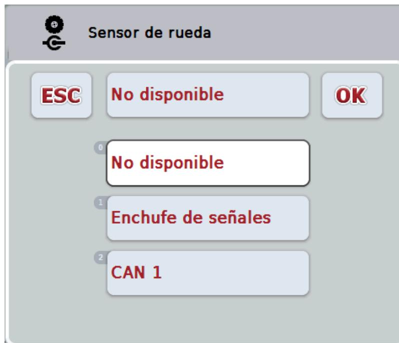
2. En la lista de selección seleccione la fuente de señal deseada. Para esto presione la pantalla táctil sobre la tecla con la fuente de señal o gire la rueda de desplazamiento hasta que la fuente de señal esté marcado en blanco. La fuente de señal aparecerá entonces en la ventana de selección.
