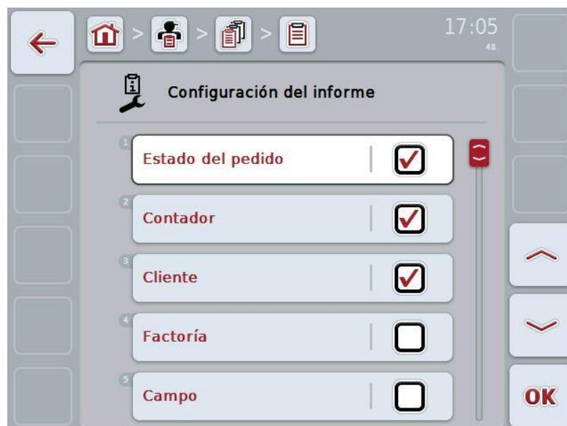
2. Seleccione los parámetros que quiere que aparezcan en el informe del pedido. Para esto presione en la pantalla táctil sobre los parámetros o gire la rueda de desplazamiento hasta que el parámetro esté marcado en blanco y presione entonces sobre la rueda de desplazamiento.
