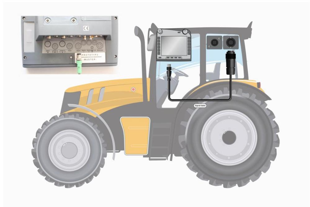
El conector de señal según ISO 11786 está equipado con los siguientes datos de sensor:
