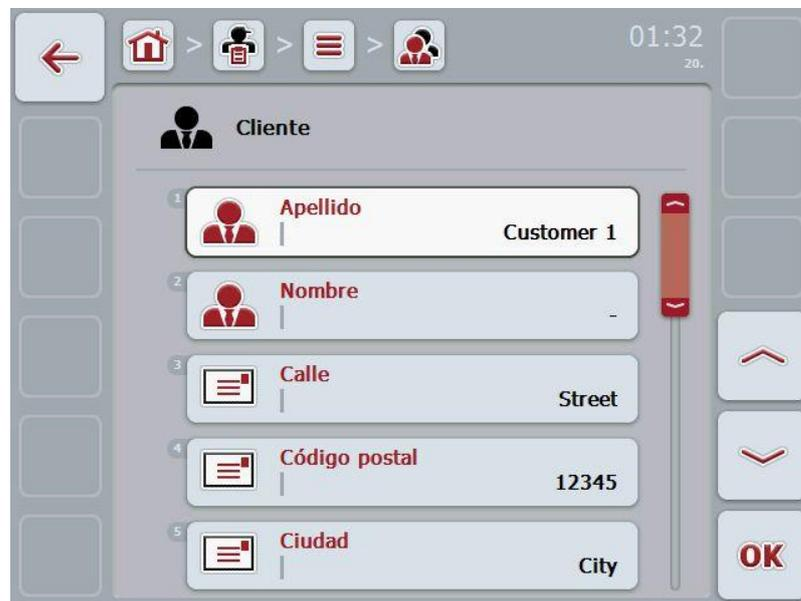
3. En la máscara de control seleccione el parámetro cuyo valor hay que editar. Para esto presione en la pantalla táctil sobre los parámetros o gire la rueda de desplazamiento hasta que el parámetro esté marcado en blanco y presione entonces sobre la rueda de desplazamiento.
