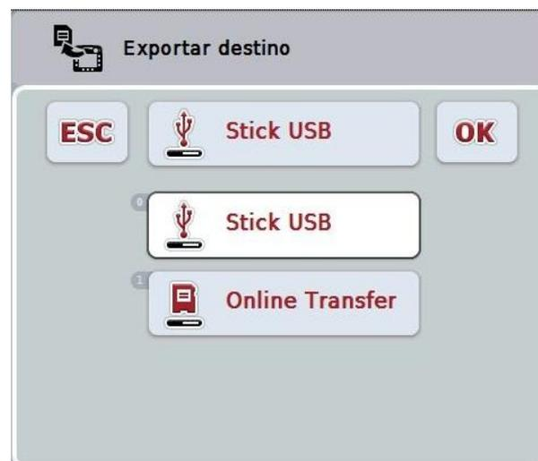
2. Seleccione entre "Stick USB" y "Transferencia online". Para esto presione sobre el botón con el trayecto de transferencia deseada o gire la rueda de desplazamiento hasta que el botón esté marcado en blanco y presione entonces sobre la rueda de desplazamiento.
