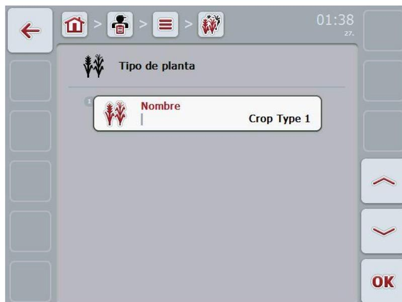
3. En la máscara de control seleccione el parámetro cuyo valor hay que editar. Para esto presione en la pantalla táctil sobre los parámetros o gire la rueda de desplazamiento hasta que el parámetro esté marcado en blanco y presione entonces sobre la rueda de desplazamiento. Cuando el parámetro esté marcado puede si lo desea presionar sobre el botón "OK" (F6).
