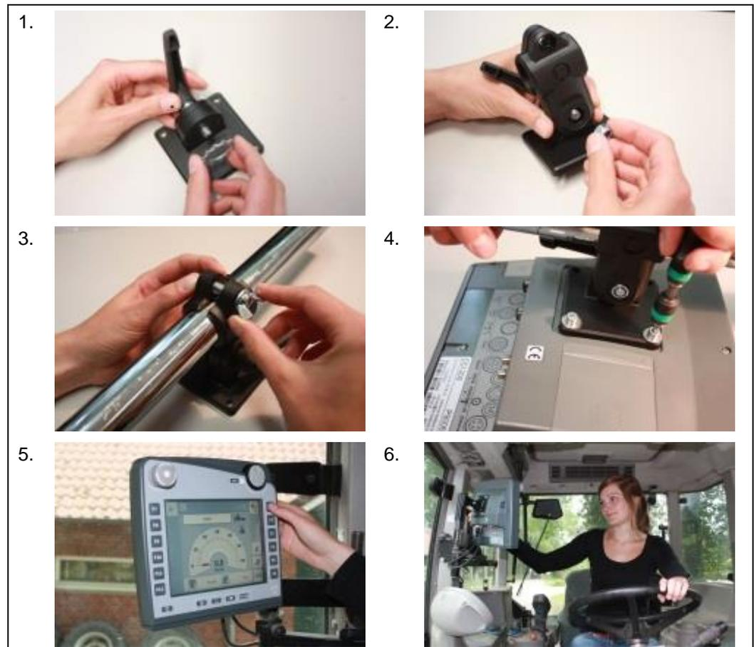
1. Assembler les éléments du support d'appareil (illustrations 1 et 2).
