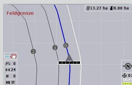
Des lignes de guidage apparaissent en fourrière. La bordure de champ sert de référence à ces lignes de guidage.
