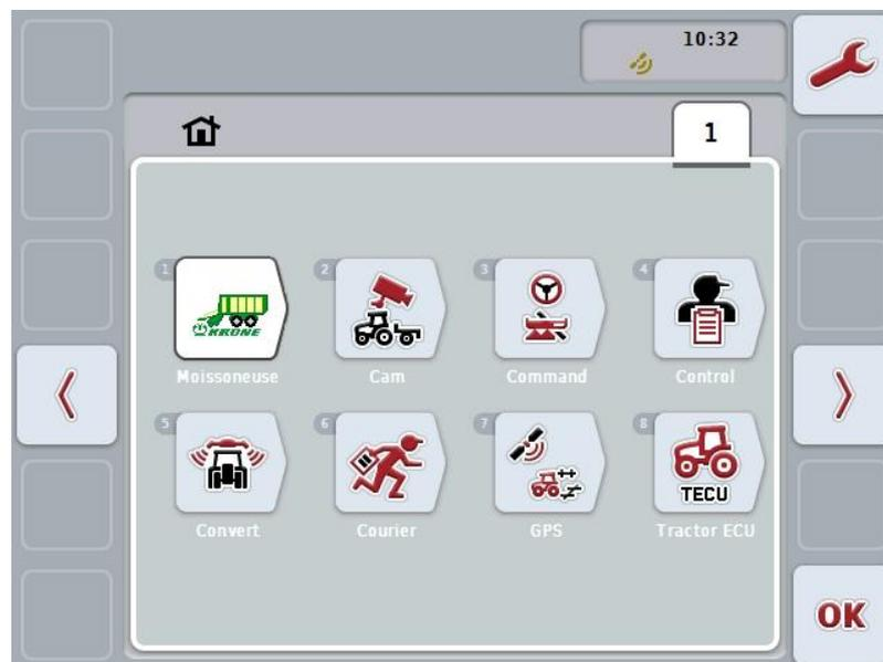
Le **menu principal** indique toutes les applications disponibles. Il s'agit des applications activées sur le terminal telles que CCI.TECU et CCI.Cam et des icônes se référant aux machines connectées.
