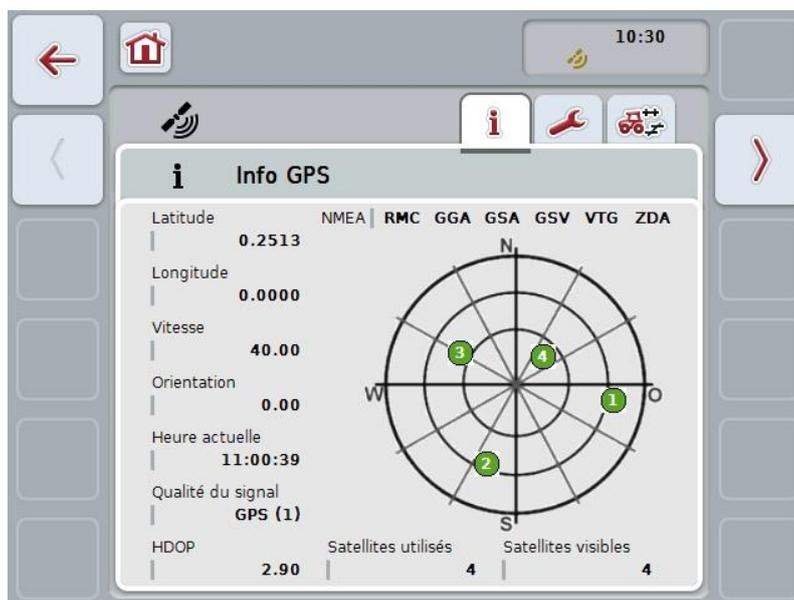
Trois onglets apparaissent dans CCI.GPS. Ces onglets contiennent les informations et possibilités de réglage suivantes :
