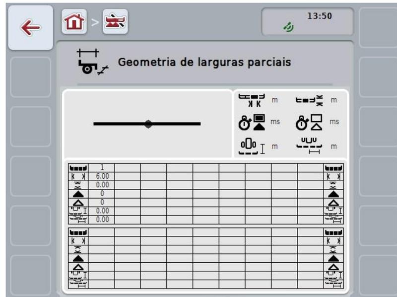
Na caixa superior esquerda, a posição das larguras parciais em relação ao ponto de referência da máquina encontra-se representada em esquema. Deste modo, pode reconhecer-se à primeira vista, se as larguras parciais se encontram todas numa linha ou se as diferentes distâncias foram configuradas na direção de condução.
