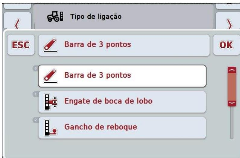
2. Selecione o tipo de montagem atual da máquina da lista. Para tal, prima no *ecrã táctil* o botão com o tipo de montagem ou rode a roda de scroll até o botão ficar marcado a branco e prima em seguida a roda de scroll.
