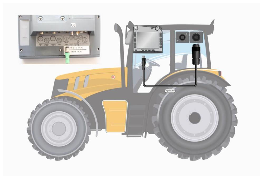
La presa di segnale conforme alla norma ISO 11786 è occupata con i seguenti dati dei sensori:
